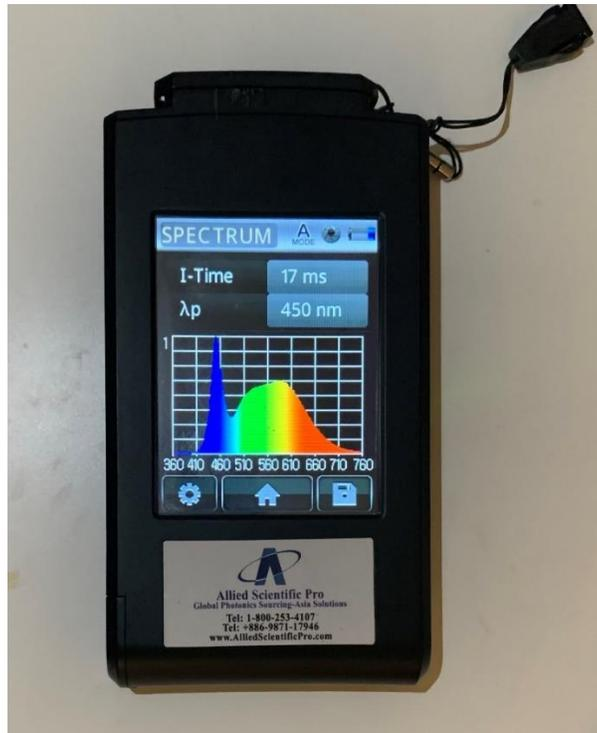
Figure 4. 8. Pro ASP-MK350 Model Illuminance Meter
